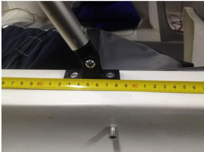
1. Установите кронштейн крепления дуг к корпусу лодки, на расстоянии 855 мм (по центру кронштейна) (см. рис)
